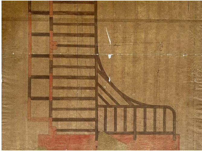
Figure 46 Plan de principe de la structure du 2 ème balcon - Plan d'archive fourni par l'architecte
